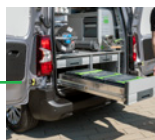
Skuffer med 100 % teleskoputtrekk og 70kg bæreevne
